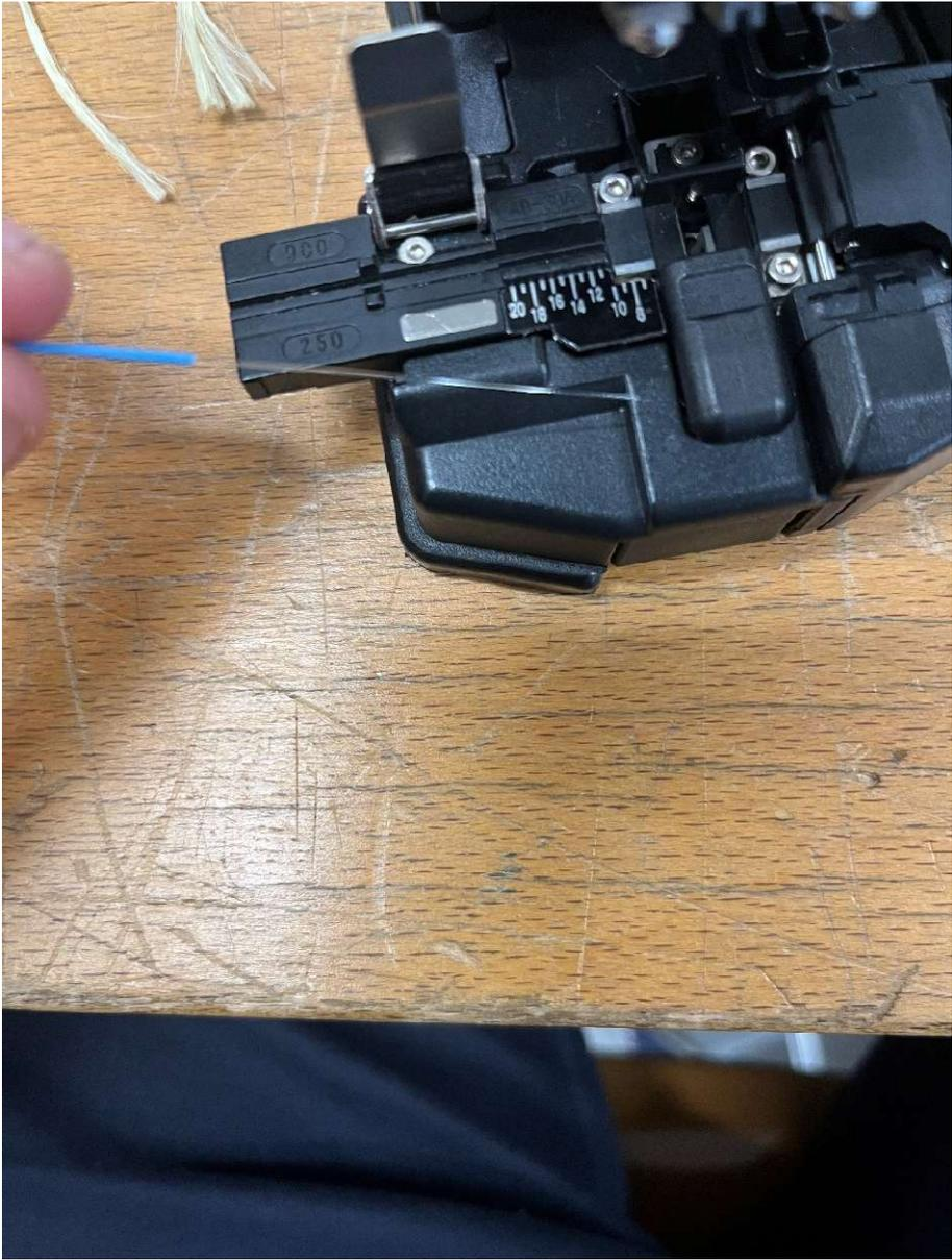
La troisième étape consiste à mettre la fibre dans un outil qui va permettre de couper proprement la fibre afin de pouvoir la souder par la suite. Il faudra donc faire ça sur les deux fibres.
